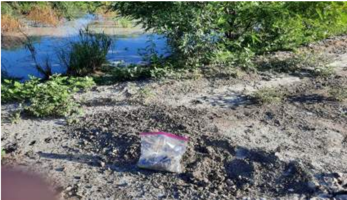
Ilustración 16 Toma de muestra de suelo para alteo de manzanas y calzada
